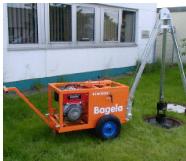
KTW 1005 na kółkach transportowych wraz z dyszlem i podporą trójnożną dla wykonywania czynności oczyszczania przepustów.
