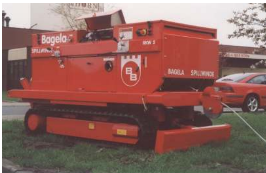
Bagela – Rohrsanierungswinde Typ RKW 5 auf einem Raupenfahrwerk Wciągarka typu Bagela RKW 5 do czyszczenia instalacji na gąsienicach
