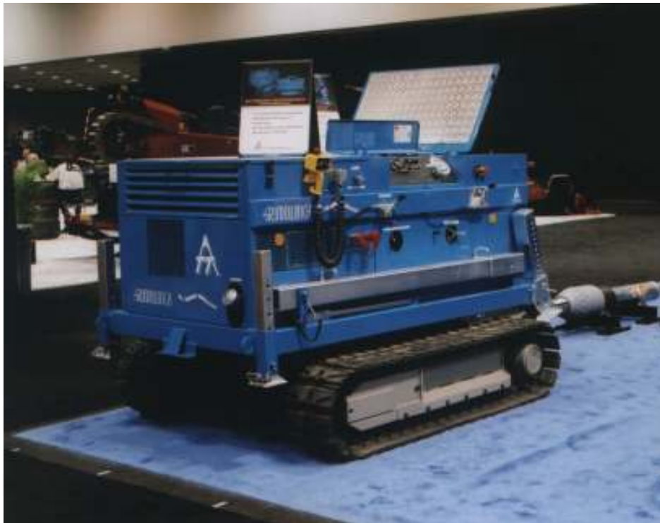
Bagela – Rohrsanierungswinde Typ RW 10 auf einem Raupenfahrwerk Wciągarka do czyszczenia instalacji typu Bagela RW 10 na gąsienicach
