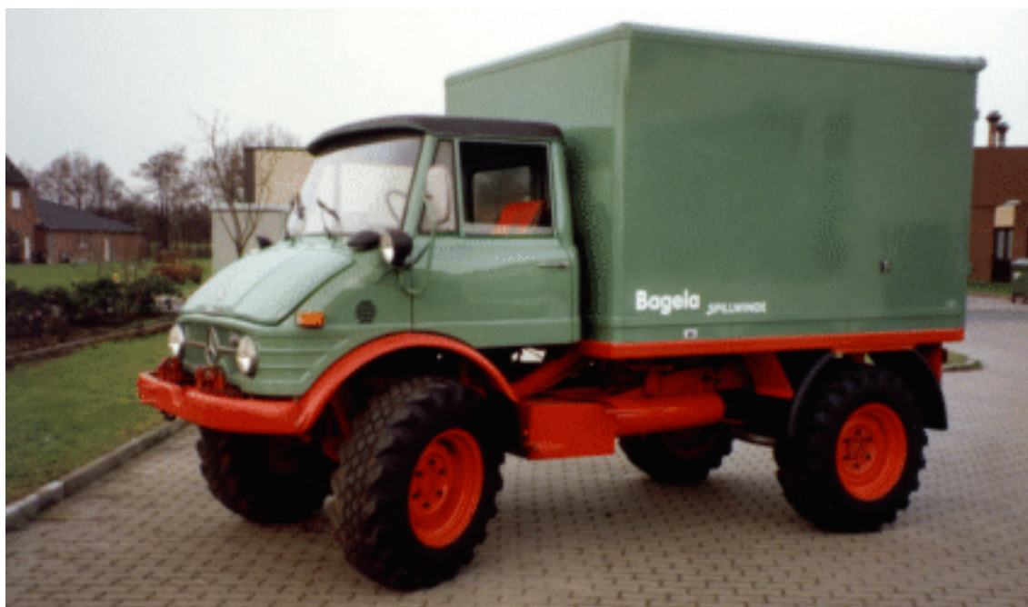
Bagela - Kabelziehwinde, aufgebaut auf Unimog, angetrieben vom Nebenantrieb Wciągarka do kabli zamontowana w skrzyni ładunkowej pojazdu transportowego Unimog, z osobnym napędem
