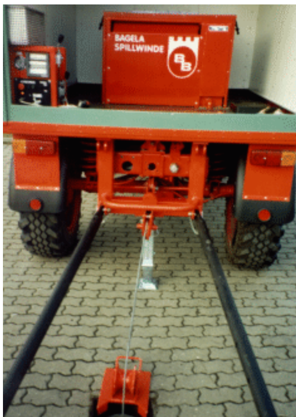
Bagela - Kabelziehwinde, aufgebaut auf Unimog, angetrieben vom Nebenantrieb Wciągarka do kabli zamontowana w skrzyni ładunkowej pojazdu transportowego Unimog, z osobnym napędem
